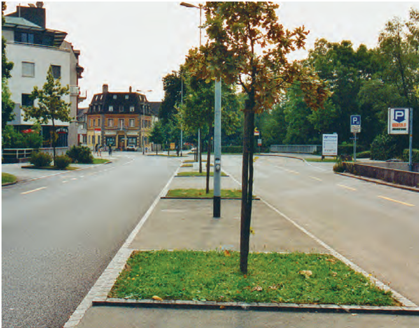
Mittelstreifen teilweise überfahrbar
