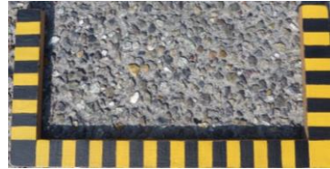
Abbildung 13: Vergleich von Waschbeton verschiedener Körnung bzgl. akustischer Belagsgüte (Quelle: Grolimund + Partner AG)
