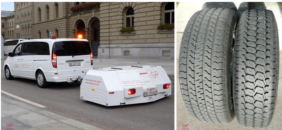
Abbildung 27: Beispiel Messanhänger und CPX-Testreifen P1 (links) und H1 (rechts) (Quelle: Grolimund + Partner AG)
