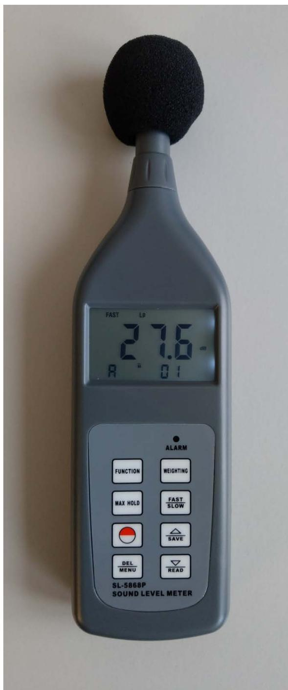
Abbildung 1: Low-cost Schallpegelmesser SL-5868P.
