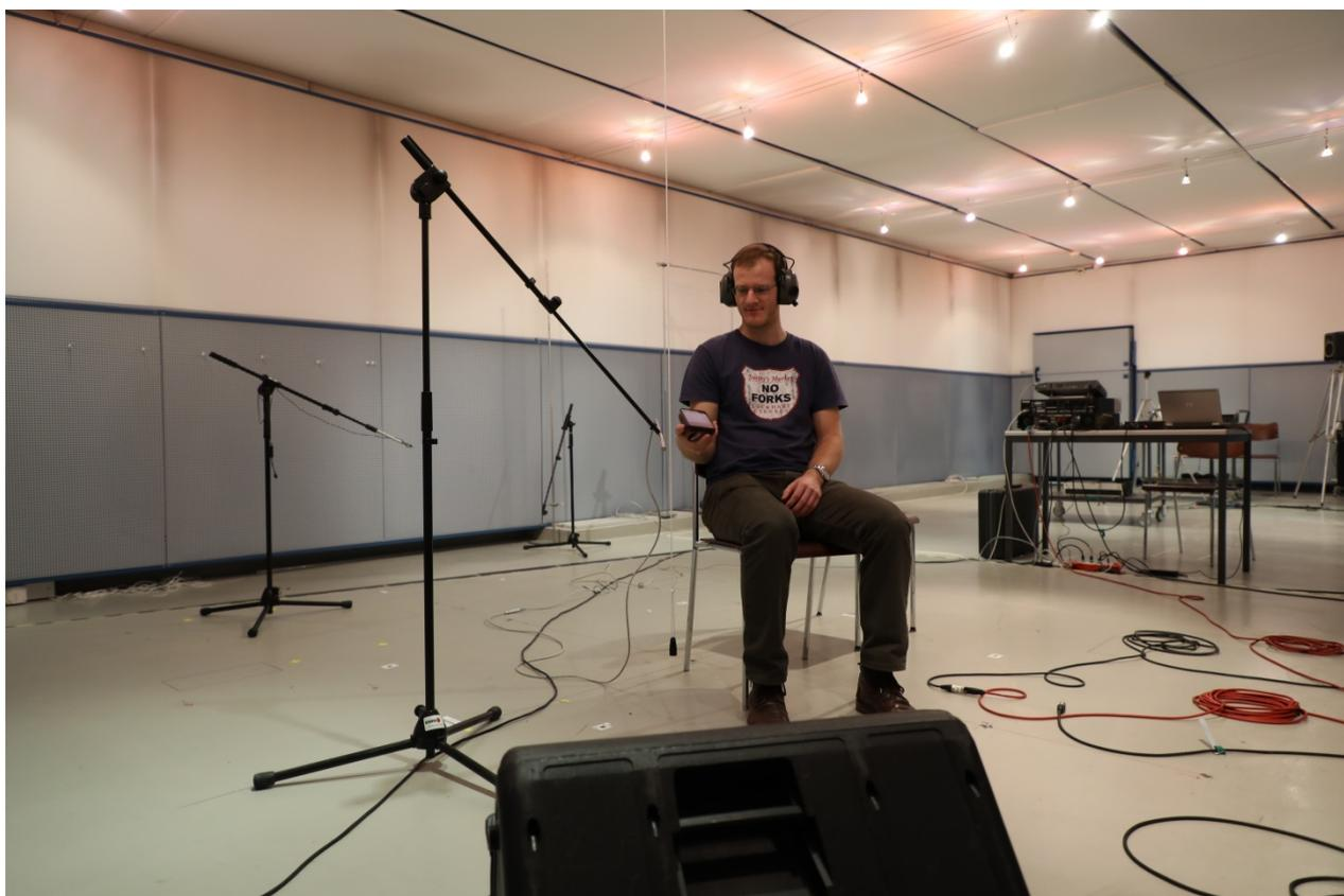
Abbildung 2: Messkonfiguration im reflexionsarmen Raum mit hartem Boden.
