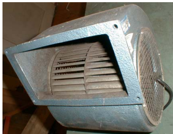
c) Radialventilator mit vorwärts gekrümmten Schaufeln ("Trommelläufer")
