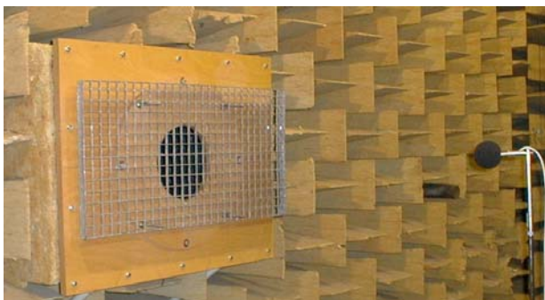
Bild D.1 Schutzgitter und Rost vor dem Windkanal im Akustiklabor (Durchmesser der Austrittsdüse = 246 mm)
